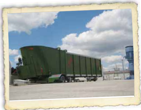
2008 Biogasbeschickung mit Vertikalmischer
