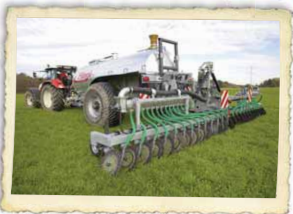
2012 Gülleinjektionstechnik: Patentierung des Scheibenschlitzgerätes
