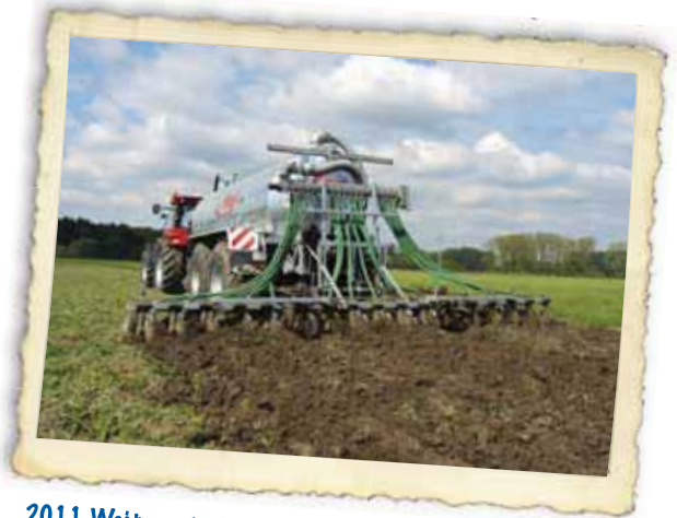
2011 Weiterentwicklung in der Gülleinjektionstechnik Scheibenschlitzgrubber »Maulwurf«
